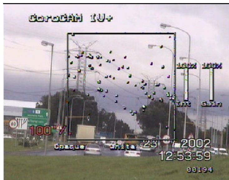
شکل (۲۷) - تصویر کرومای ناشی از آلودگی روی هادی خط انتقال
