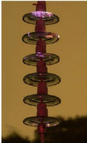
شکل (۱۳) - کرونای ناشی از رطوبت و آلودگی گسترده شده در سطح مقره
