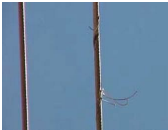
شکل (۲۴) - عکس معمولی رشته گسیخته شده از هادی خط انتقال
