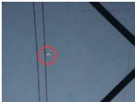
شکل (۲۵) - تصویر کرومای ناشی از رشته گسیخته شده هادی خط انتقال نیرو
