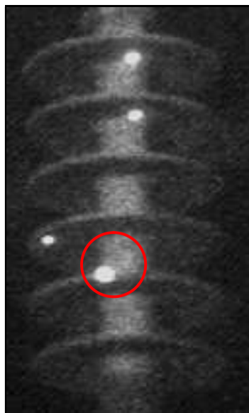
شکل (۱۹) - کرونای ناشی از تجمع قطره ای آب بر روی مقره سیلیکونی
