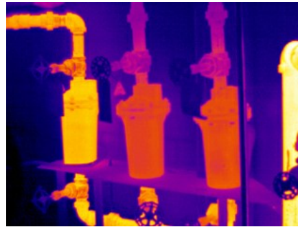
شکل - ۲۰ : نشت بخار در داخل یک تله بخار
