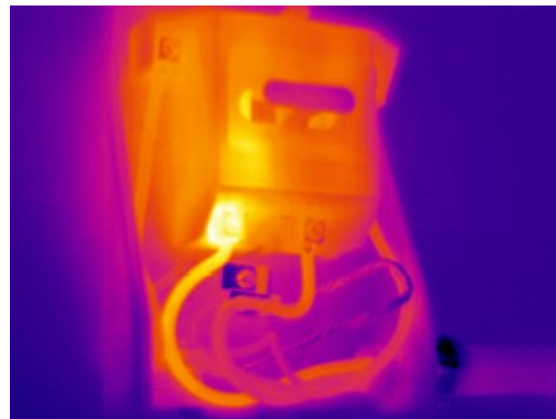
شکل - ۹: آشکار سازی محل عیب در جعبه تغذیه برق یک وسیله برقی
