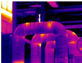
شکل - ۲۱ : نشت بخار از مسیر سیال
